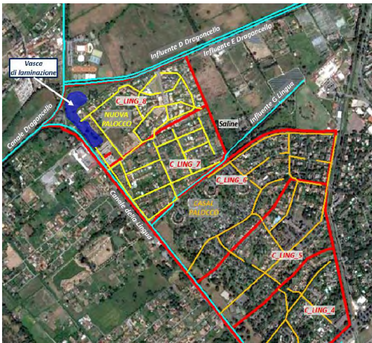
Fig. 22: Sottobacini del canale della Lingua (da C_LING_4 a C_LING_8) (Fonte: Università Roma Tre)
