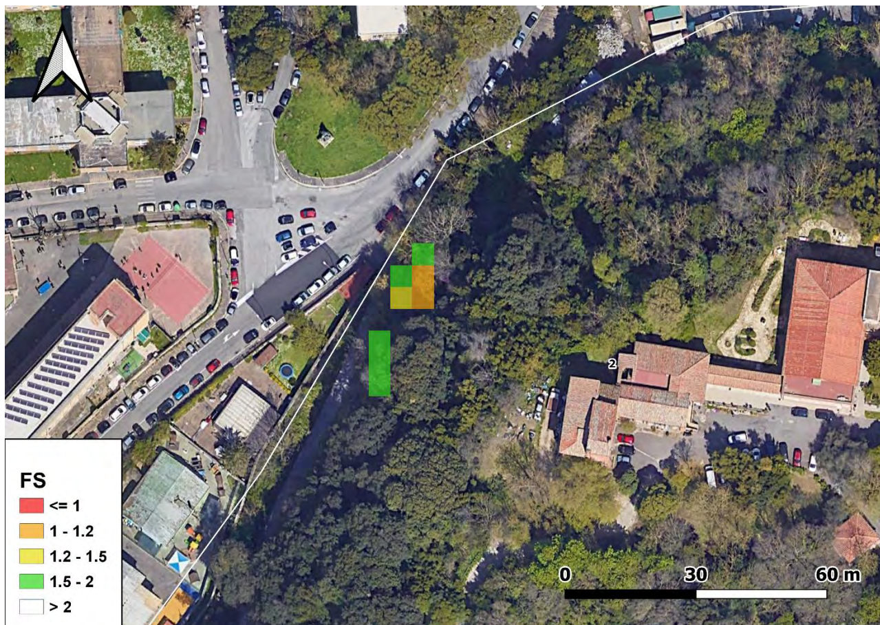
Fig. 9: carta del FS ottenuta con TRIGRS per lo scenario 3-giorni/ T_r -10 anni, saturo per l'area 2 (Villa Glori).
