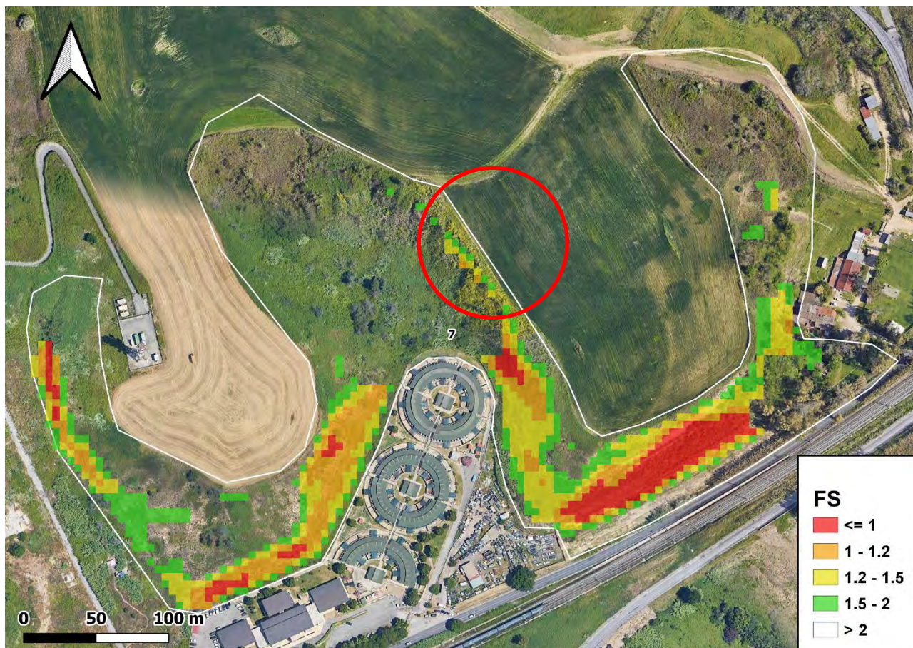
Fig. 13: Carta del FS per lo scenario 48-ore/ T_r -10 anni, saturo (condizioni più gravose). L'area evidenziata (cerchio rosso) mostra il raggiungimento di condizioni di instabilità in un settore già interessato da movimenti franosi durante l'evento del 2014.
