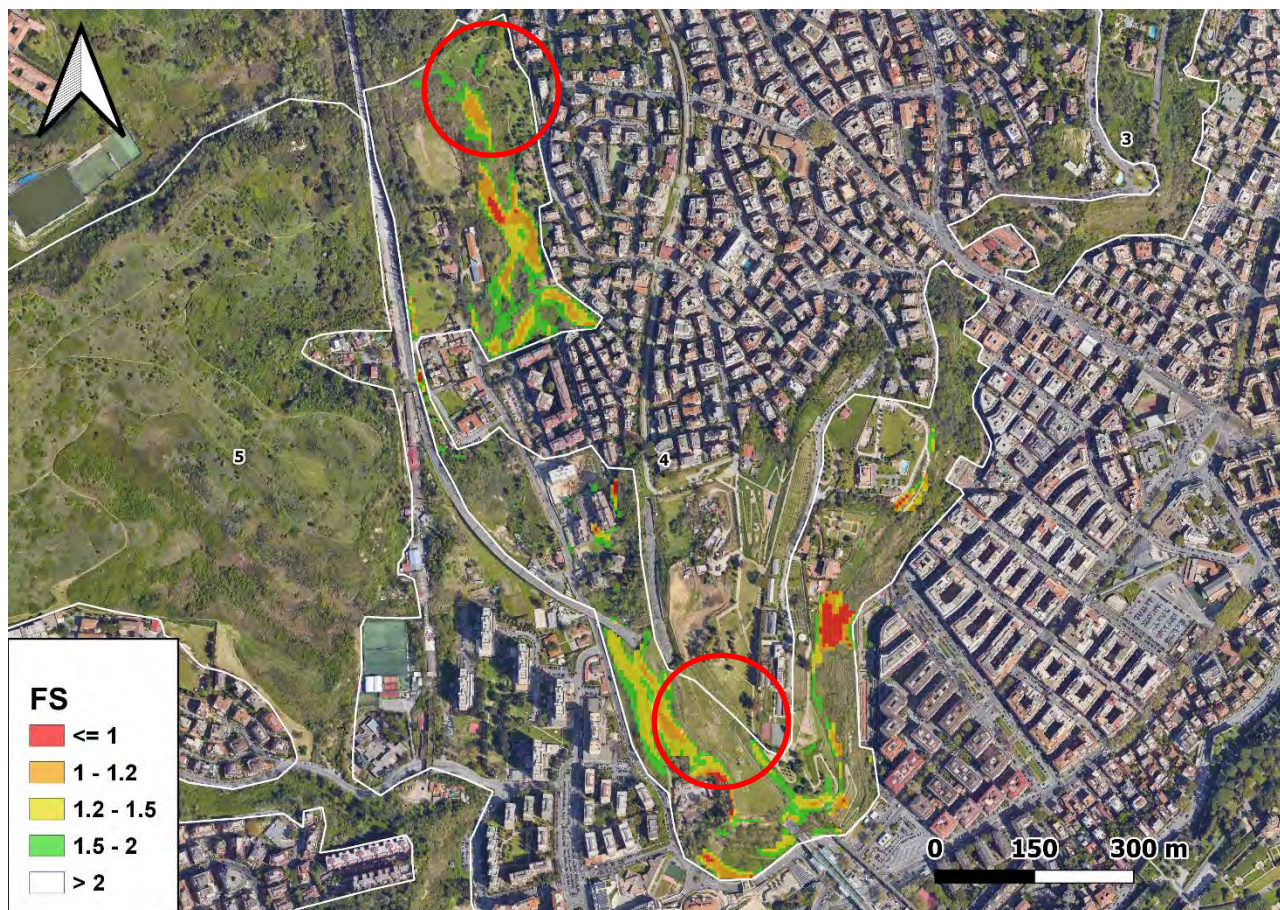
Fig. 6: Carta del FS per lo scenario 48-ore/ T_r -10 anni, in condizioni di saturazione dei terreni (scenario più gravoso). Le aree evidenziate (cerchi rossi) sono quelle in cui si raggiungono condizioni di instabilità.
