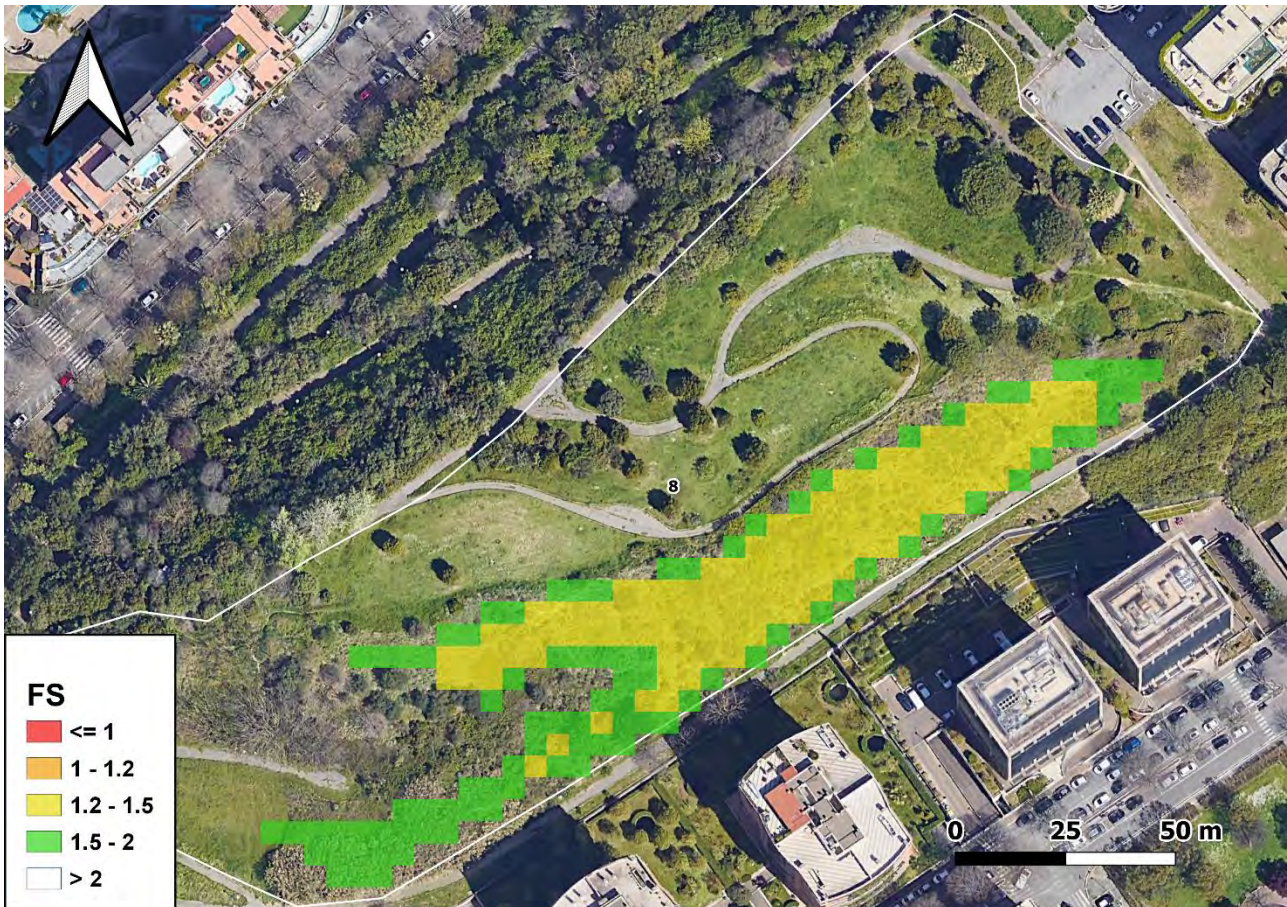
Fig. 10: Carta del FS per lo scenario 1-ora/T-2 anni, asciutto (condizioni meno gravose).
