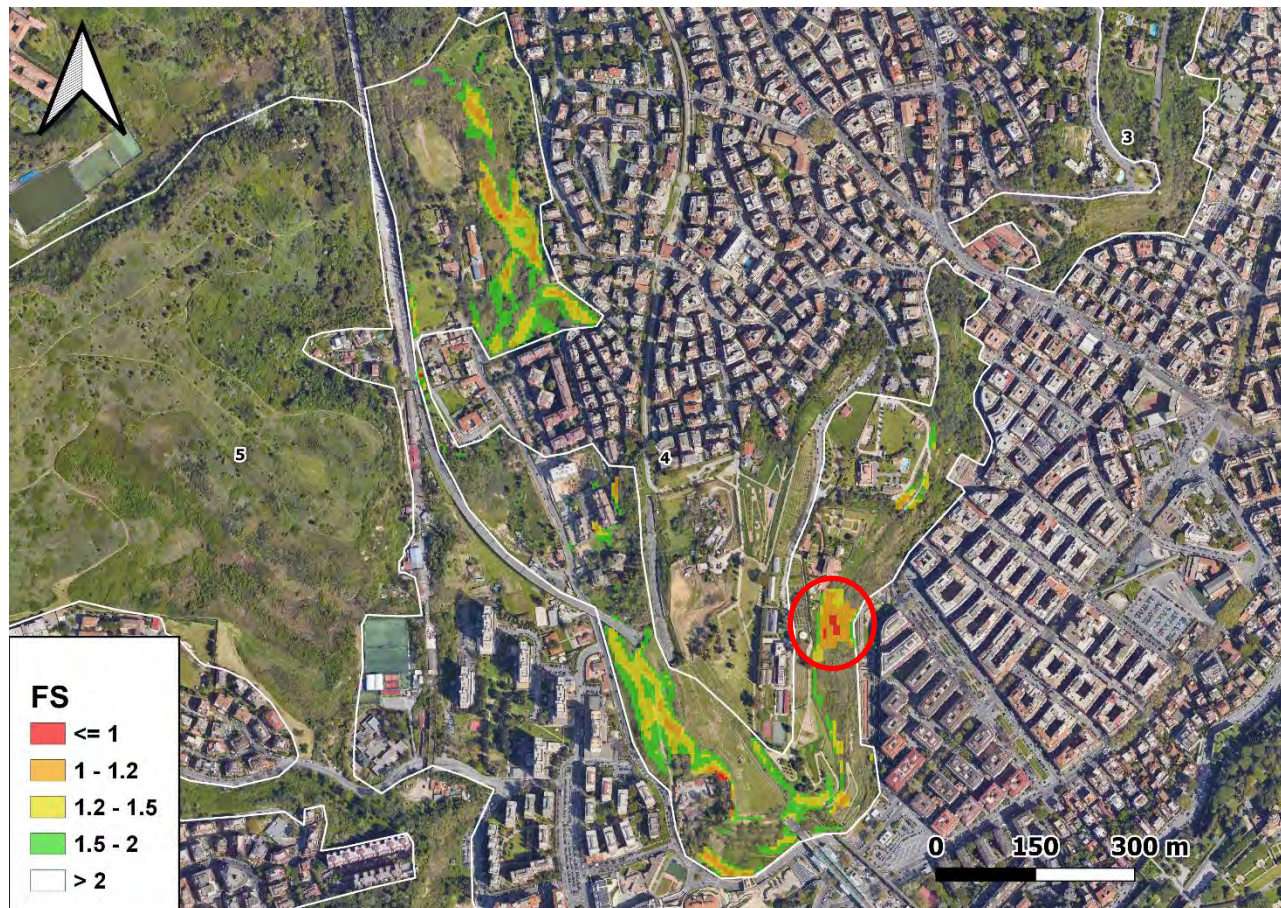
Fig. 5: Carta del FS per lo scenario 48-ore/ T_r -2 anni, asciutto (scenario meno gravoso). L'area evidenziata (cerchio rosso) è quella caratterizzata da condizioni di instabilità progressive.
