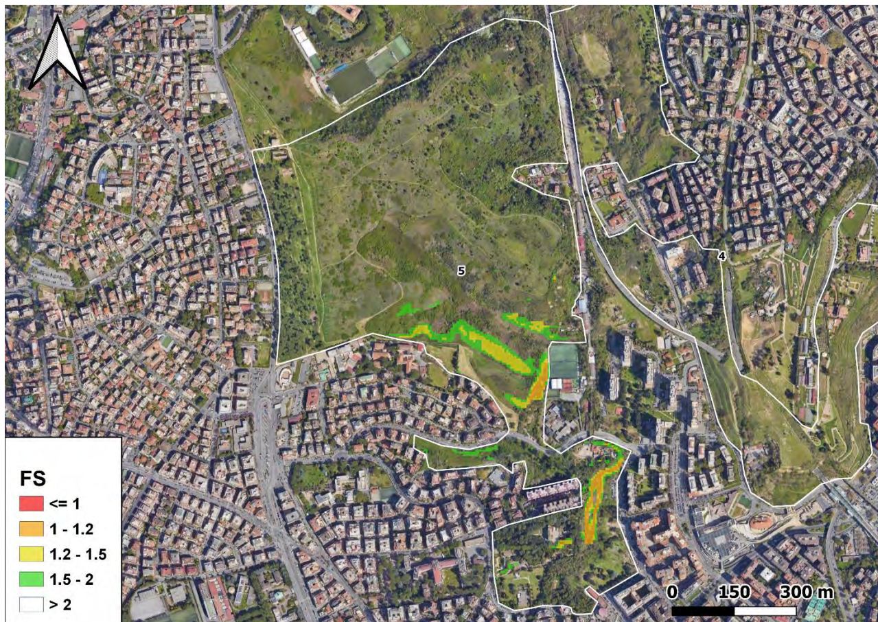
Fig. 14: Carta del FS per lo scenario 1-ora/T-2 anni, asciutto (scenario meno gravoso).
