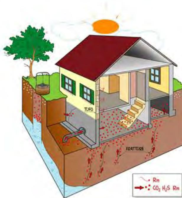
Fig. 1: Principali sorgenti di CO<sub>2</sub>, H<sub>2</sub>S e <sup>222</sup>Rn.
