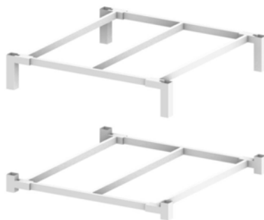
Travi in acciaio connesse con i pilastrini lignei per sostenere le capsule
